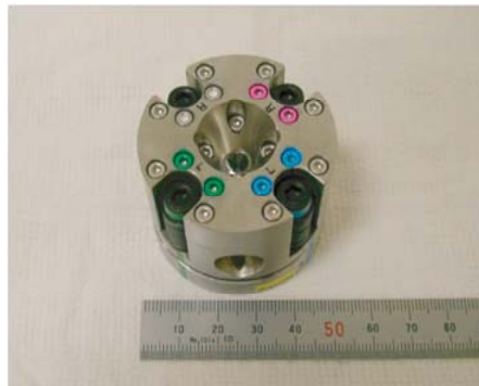
5cmの程のダイヤモンドアンビルで 地球中心圧力の実現を目指す。
